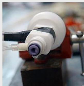
*Figura:* Dispositivo de medição automatizada da pressão vesical
